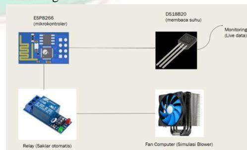
Mikrokontrol yang terhubung sensor suhu dan saklar otomatis untuk menghidupkan dan mematikan kipas. Dengan alur program sebagai berikut:
